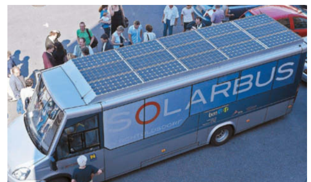
Die Photovoltaikzellen auf dem Dach des Solarbusses leisten einen wesentlichen Beitrag zur Energieversorgung des Fahrzeugs.
